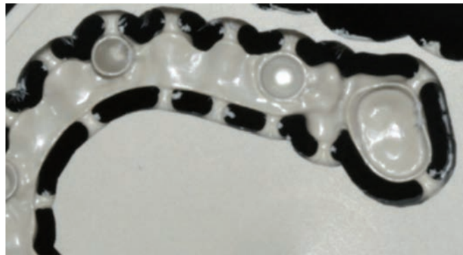
Fig. 1 et 2: Armature (gauche: basale, droite: occlusale), disque dentaire Juvora fabriqué selon un procédé à base de CAO/FAO
