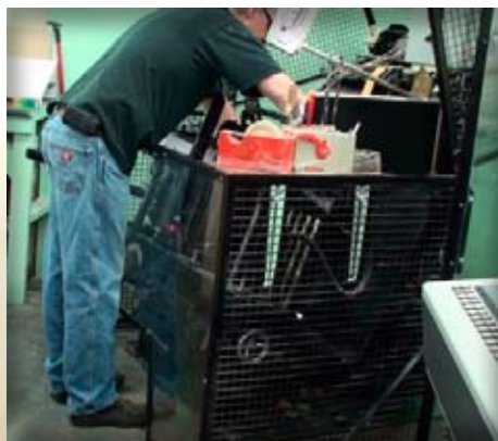
Une ouverture a été pratiquée dans le bas du protecteur. Ainsi, l'opérateur a la possibilité de se rapprocher de la zone de travail en ayant une posture moins contraignante.
