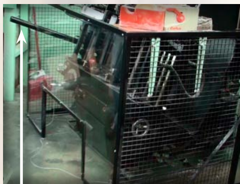
Bras de levier servant à embrayer ou désembrayer le lien entre la roue d'inertie et le mécanisme de la presse.
