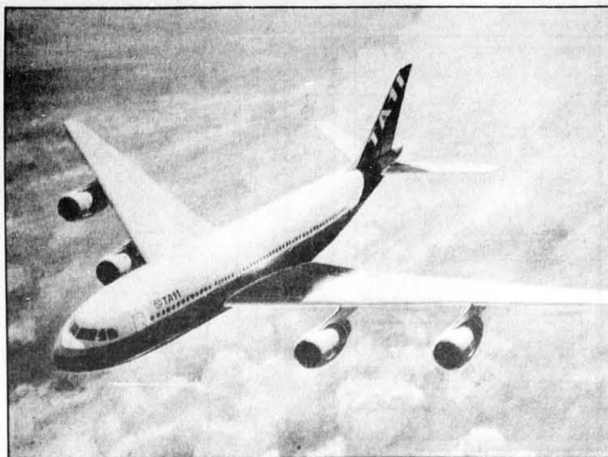
Actuellement sur les planches à dessin d'Airbus, le TA11 pourra transporter 250 passagers sur plus de 10 200 kilomètres. Cet avion des années 90 promet un coût de transport inférieur à celui de tous les quadrimoteurs actuellement en service.
