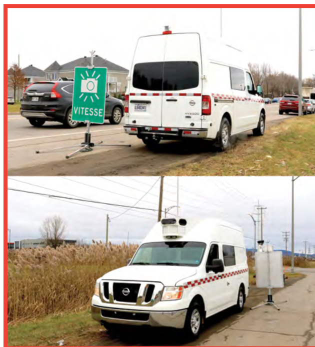
Photo 2 - ACA mobile vitesse dans une fourgonnette
