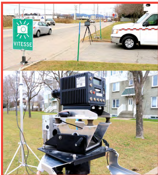
Photo 3 – ACA mobile vitesse posé sur un trépied
