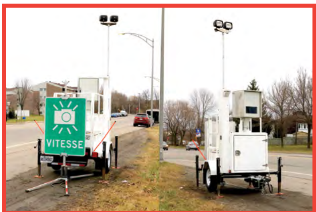
Photo 4 – ACA mobile vitesse sur une remorque
