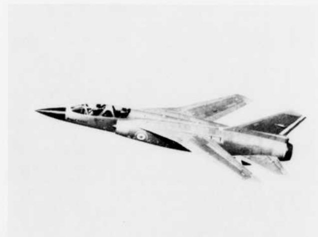
Mirage G — ailes déployées à 55^\circ .
