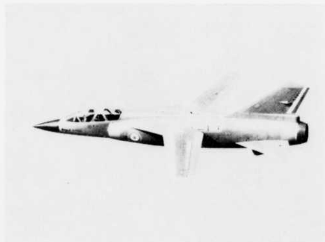
Mirage G — ailes déployées à 20^\circ .
