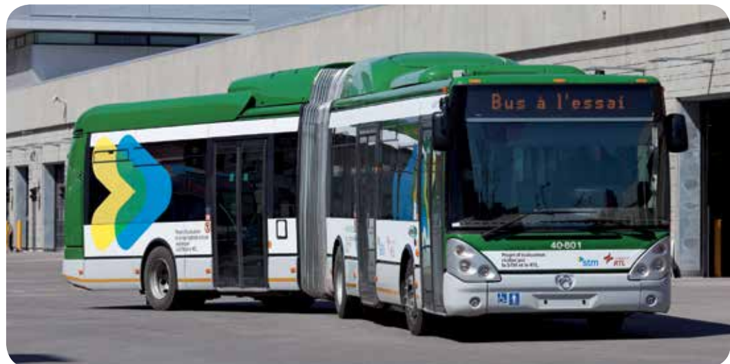
Bus articulé hybride diesel-électrique Irisbus-Iveco
