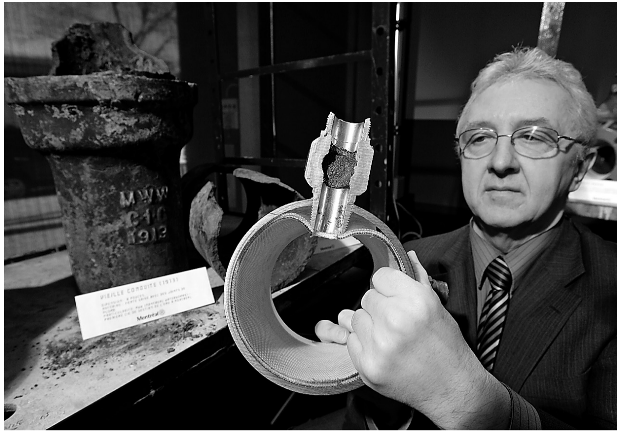
PHOTO ALAIN ROBERGE, LA PRESSE Réjean Lévesque, directeur de la gestion de l'eau à la Ville de Montréal, montre un exemple de tuyau réparé avec une membrane spéciale, une procédure qui prolonge la durée de vie des conduites d'eau. À l'arrière-plan, une conduite datant de 1913.
