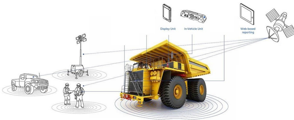
Figure 1 Exemple de système centralisé de détection de proximité pour une mine à ciel ouvert (Source : GE-Transportation).
