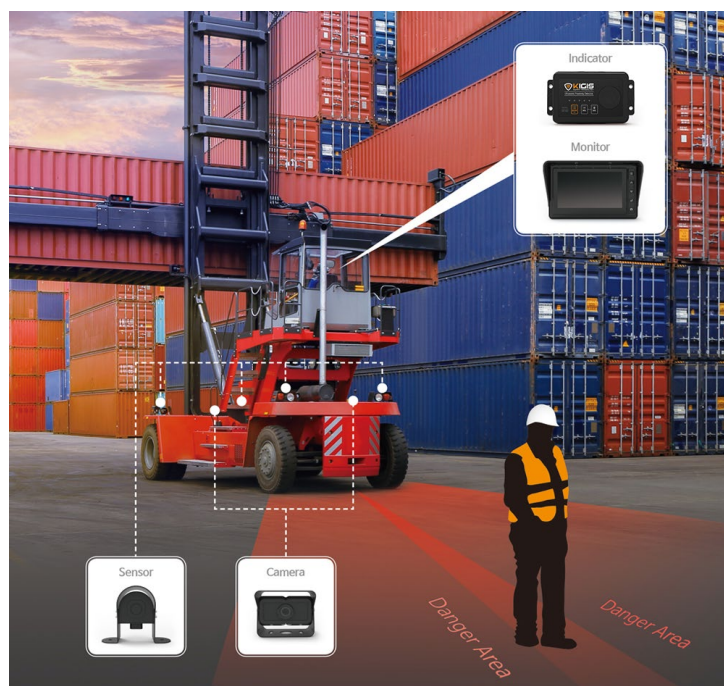
Figure 7. Exemple d'un système de détection de proximité à ultrasons (Source : Kigistec).
