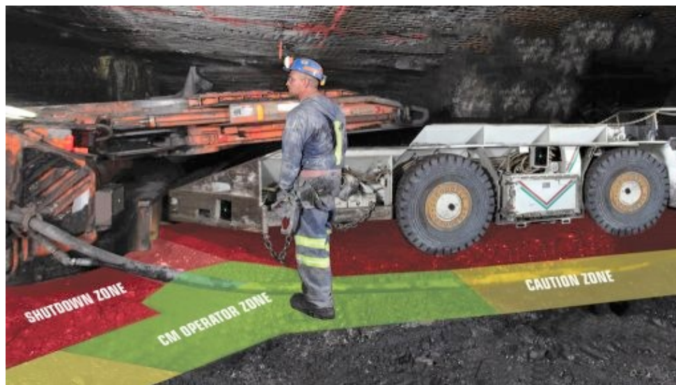
Figure 3. Exemple de création de plusieurs zones de détection de proximité pour un équipement de mine souterraine (Source : Matrix Design Group LLC).
