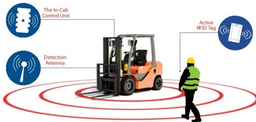
Figure 4. Illustration schématique d'un système de détection de proximité basé sur l'identification par radiofréquence (Source : Zonesafe).
