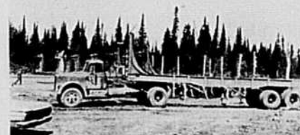
Camion pouvant facilement être chargé par l'arrière: le bois glisse facilement vers l'avant grâce à la structure en demi-rond du devant de la plate-forme.
