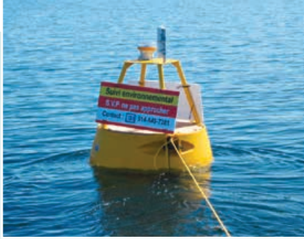
Bouée instrumentée présente en avril 2013 à la station P1 dans le chenal de Mingan
