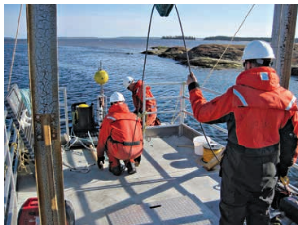
Déploiement d'un courantomètre et d'une sonde multiparamètre permettant de mesurer la conductivité (salinité), la température, la profondeur et la turbidité de l'eau de l'embouchure de la Romaine
