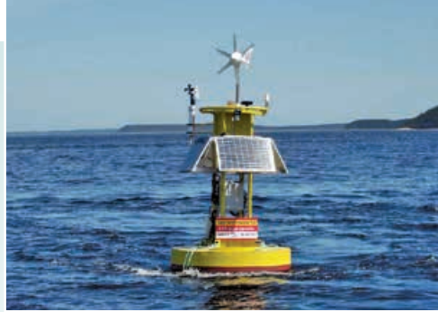
Bouée instrumentée déployée de mai à septembre 2013 à la station P2 dans le chenal de Mingan
