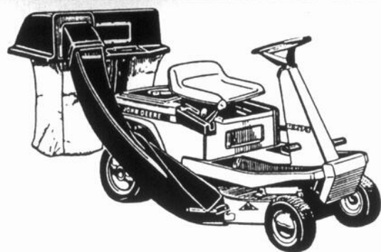
Tondeuse à siège RX73 avec ensacheur arrière de 6,5 boisseaux
