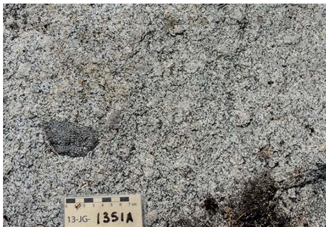
PHOTO 13 - Granodiorite massive à biotite, hornblende et magnétite, porphyrique à phénocristaux de feldspath potassique blanchâtres avec enclaves de diorite, Pluton de Pichi, Suite de Richardie (33H03, 2013-JG-1351, site de l'échantillon de la datation U-Pb).
