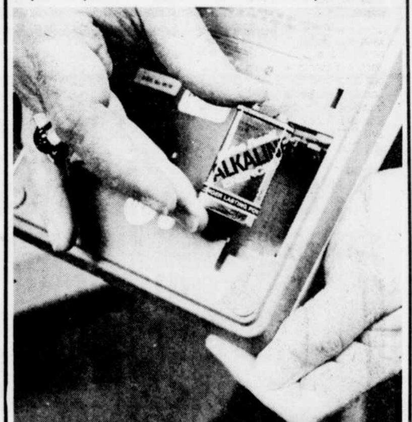
Cette petite pile permet, sur certains appareils, de conserver la mémoire de l'appareil en cas de débranchement. Son code de protection évitera que d'autres appareils, émettant sur une fréquence similaire, ne puissent faire d'interurbains portés à votre compte!
