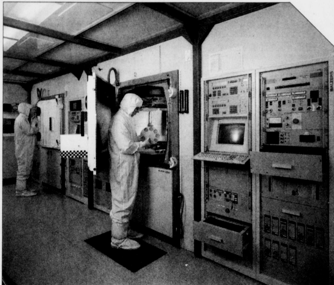
La fabrication de couches minces optiques très denses qui trouvent des applications en astronomie, en environnement extrême et en télécommunications.
