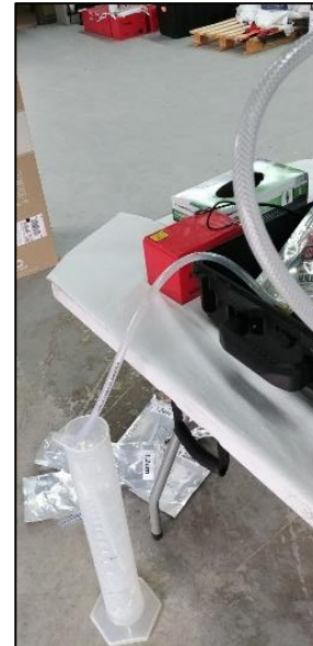
Figure 14. Cylindre graduée positionné en contrebas de la pompe
