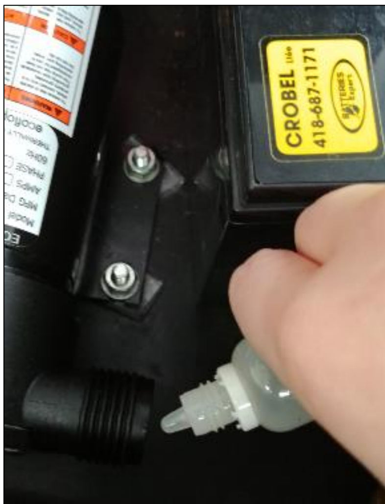
Figure 10. Préparation de la pompe avec l'ajout d'huile
