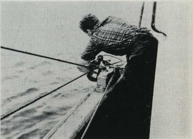
Fig. 8 (en haut). Lorsque le chalut est sur le fond, les funes sont réunies par la « main » de fer.
