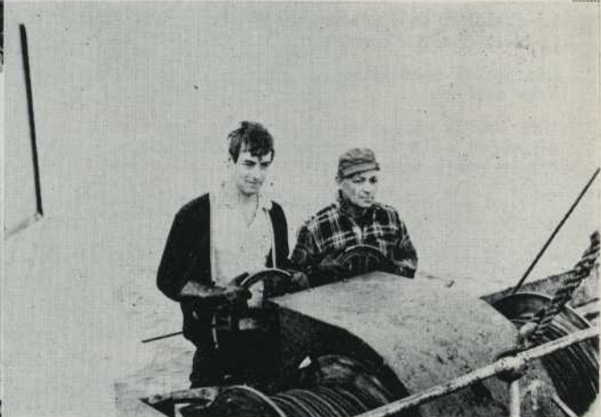
Fig. 7 (en haut). Le treuil, d'une capacité de 500 brasses (3 000 pieds), assure la descente régulière et la remontée du chalut.
