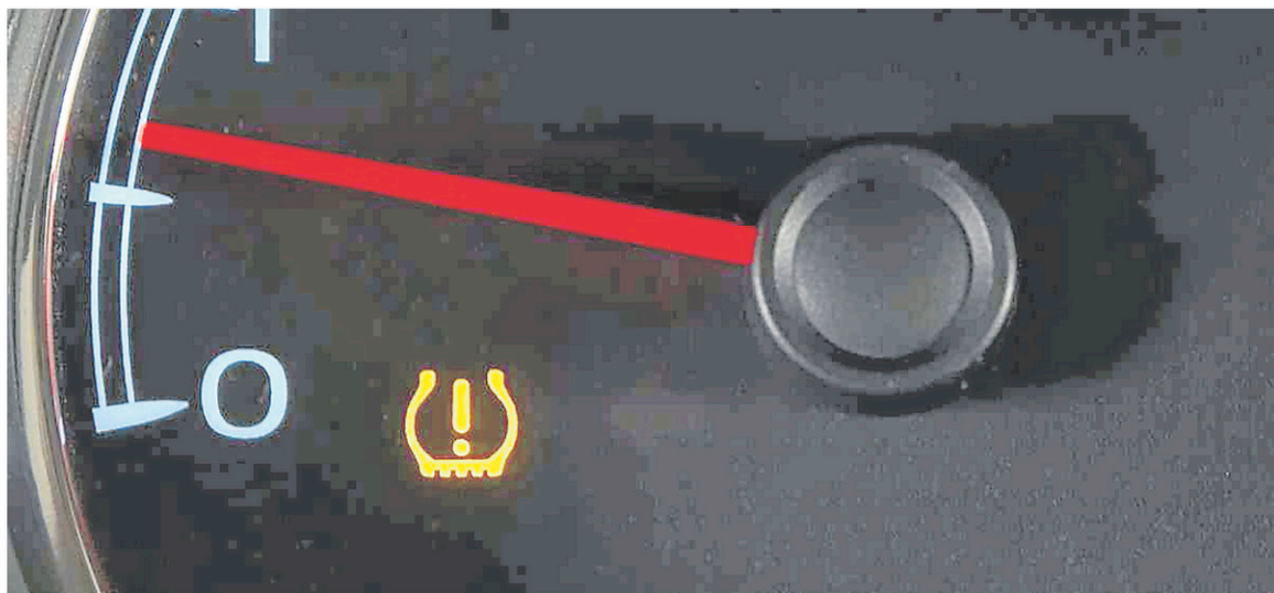
L'absence de capteurs de pression des pneus fait allumer le témoin d'alerte dans le tableau de bord. — PHOTOTHÈQUE LE SOLEIL
