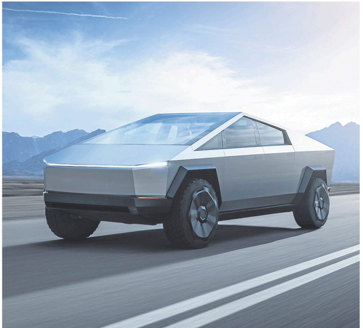
Le Cybertruck de Tesla est construit en acier inoxydable laminé à froid qui ne peut être façonné de façon traditionnelle, car cela brise des presses à matricer. — PHOTO FOURNIE PAR TESLA
