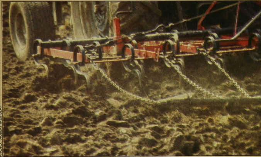
L'écartement entre les dents du vibroculteur varie selon les exigences de finesse d'émiettement.
