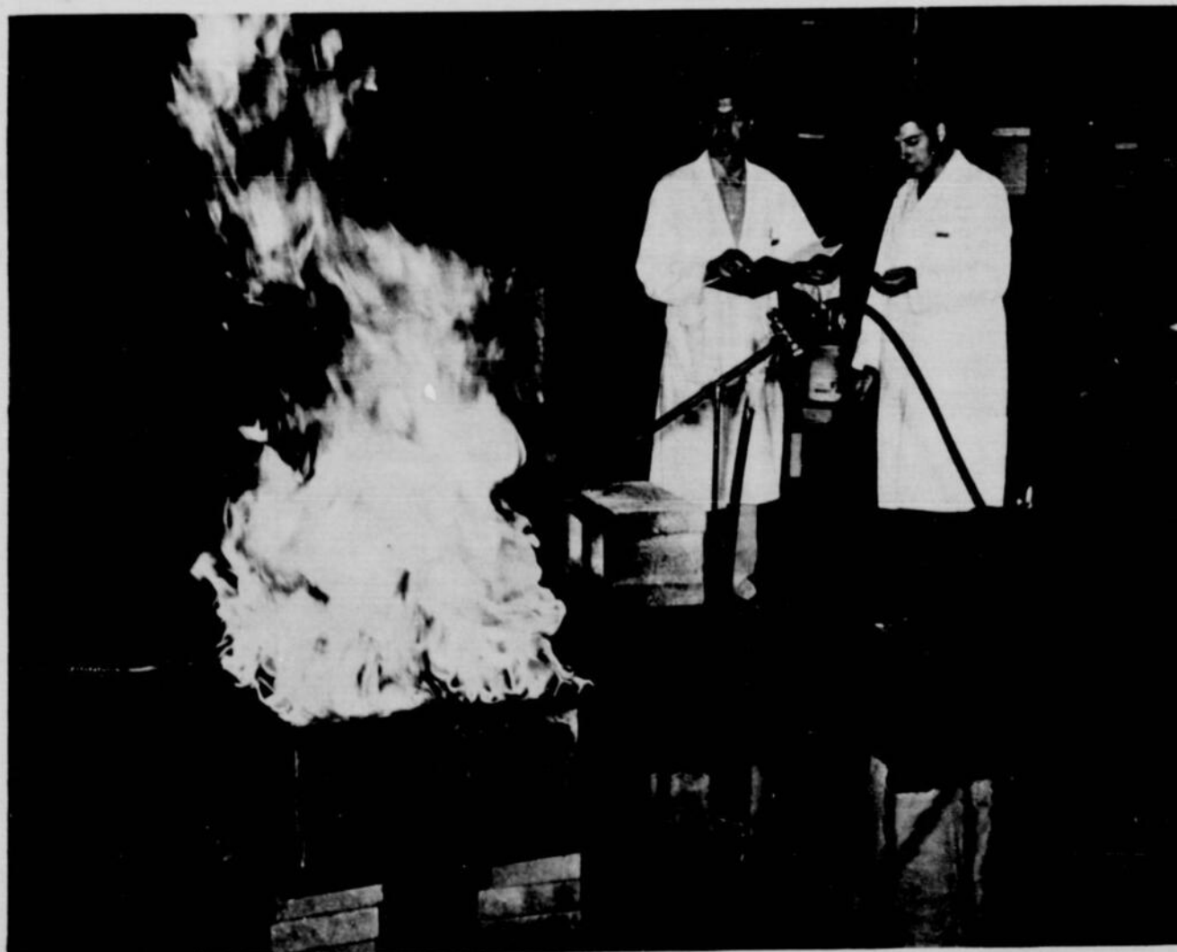
△ Recherches sur les mousses chimiques. — On vient de mettre le feu à une nappe d'essence contenue dans un réservoir. Les techniciens du Laboratoire du Feu, montre en main, s'apprêtent à lancer sur les flammes un produit extincteur.
