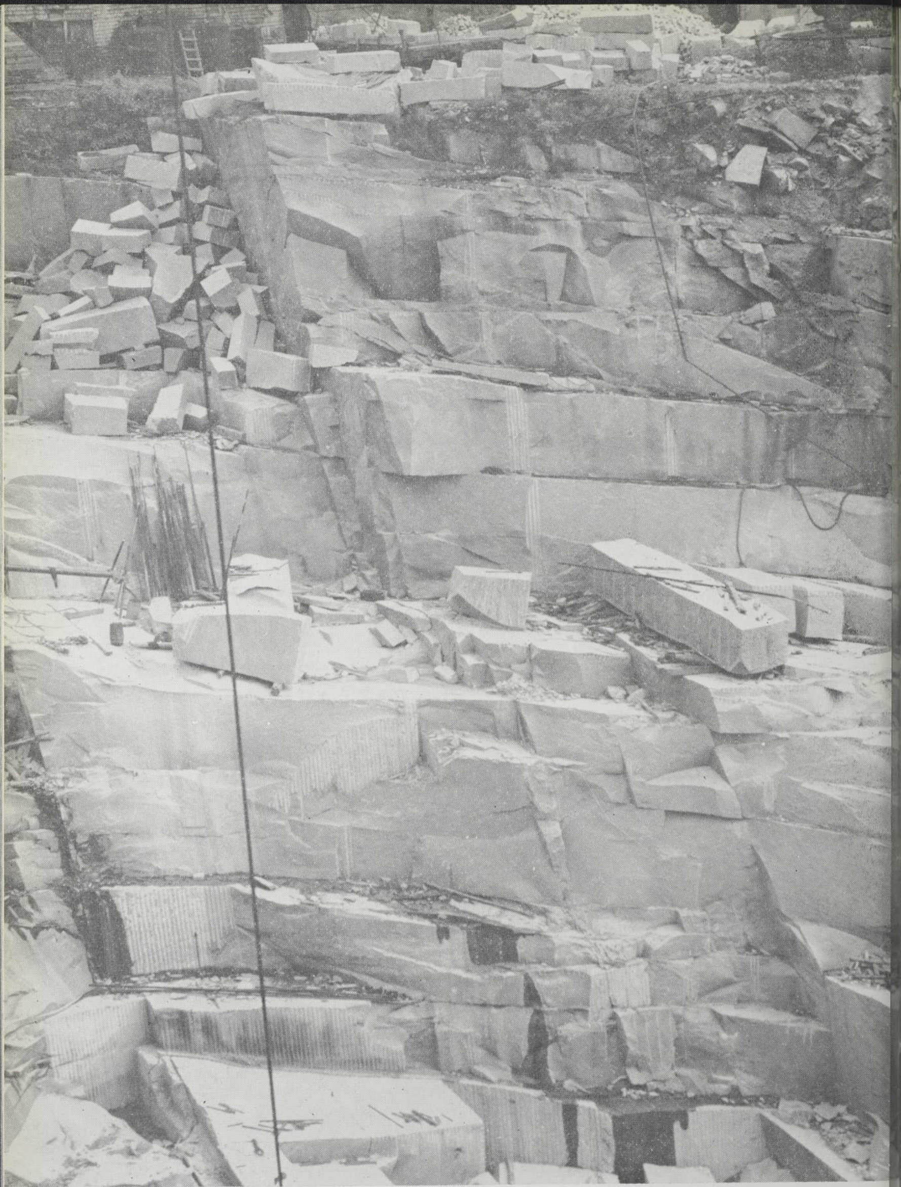
Carrière de granit à Guenette, dans les Laurentides. Les granits de la province de Québec sont très employés, dans tout le Canada, aussi bien comme matériaux de construction que comme pierres ornementales.
