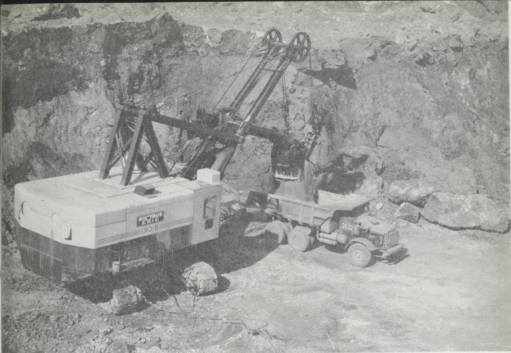
A la mine French, à Schefferville: d'un seul coup, cette pelle électrique déverse huit verges cubes de minerai de fer dans un camion Diésel. Courtoisie d'Iron Ore Company of Canada.
