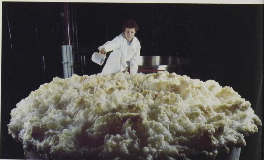
À la microbrasserie McAuslan, chaque cuve contient 5000 litres de bière (chez Molson O'Keefe, elles en contiennent 80 000 litres). La fermentation de la bière produit beaucoup de mousse, qu'il faut écumer par différents procédés.
