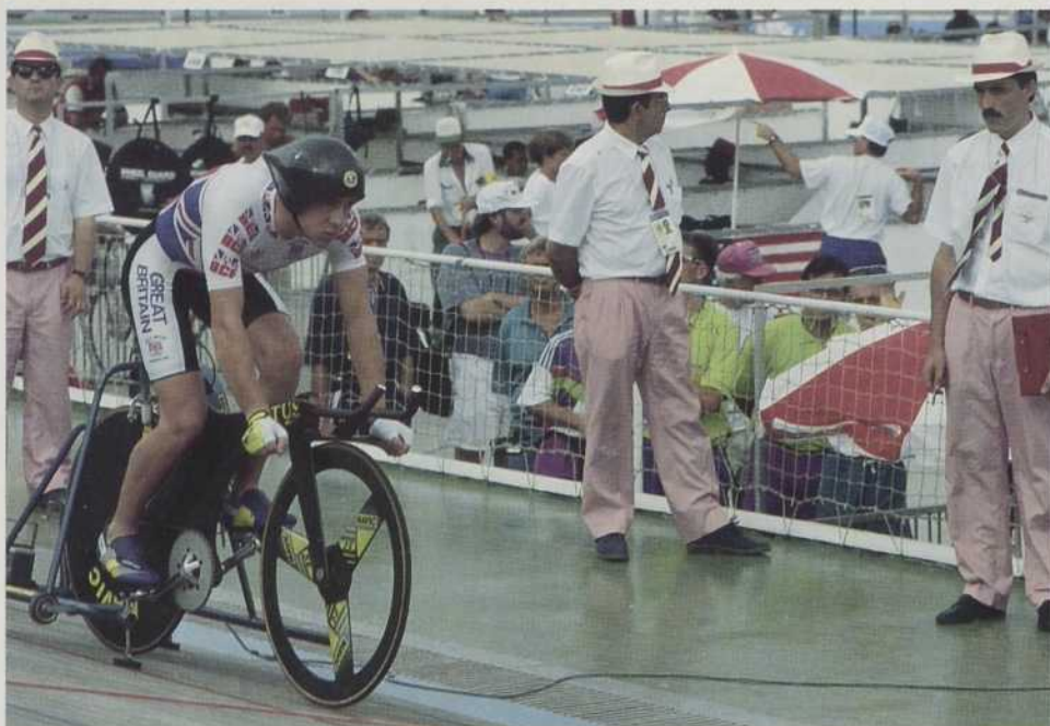
Avec son vélo à cadre cantilever muni d'un monobras, le Britannique Chris Boardman a retranché sept secondes au record du monde de poursuite pendant les jeux olympiques de Barcelone.
