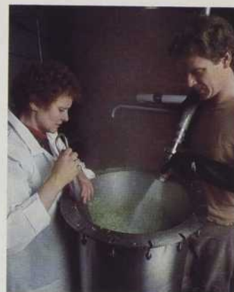
Chez McAuslan, l'arôme des fleurs de houblon est extrait dans l'eau chaude à 85 °C.
