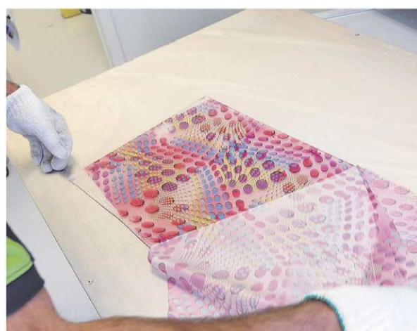
Mise au four de la feuille de plastique; à la température de formage, on peut ajouter des imprimés de couleurs si désiré. Puis, en utilisant une pompe à vide, le plastique épouse parfaitement la forme du positif.
