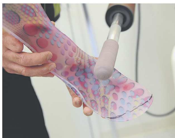
Sablage et polissage du plastique.
