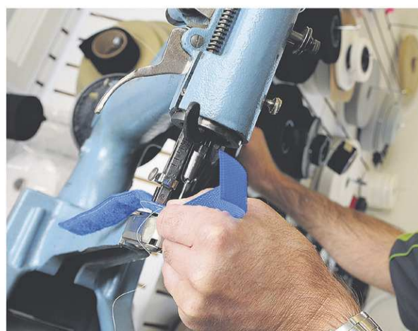
Confection des courroies de velcro à l'aide de la machine à coudre.
