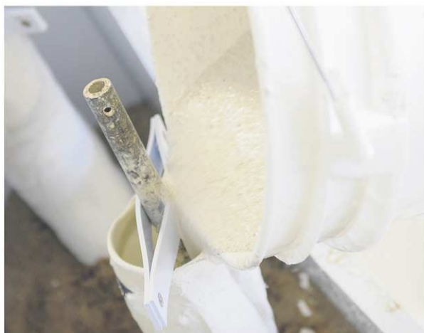
Coulage du négatif avec du plâtre liquide.
