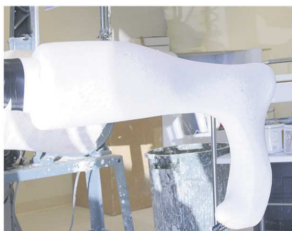
Polissage du positif et préparation de ce dernier au moulage du plastique.
