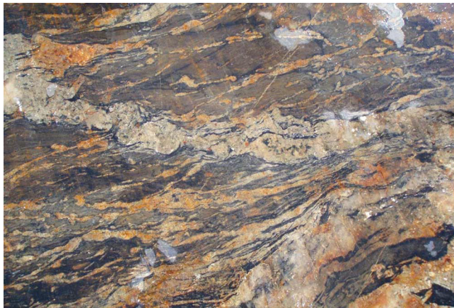
PHOTO 3 - Altération proximale associée aux minéralisations de la zone de Roberto. Stockwerk de veines plissées et contenant de la tourmaline, du quartz de la pyrrhotite, de la pyrite et de l'arsénopyrite.
