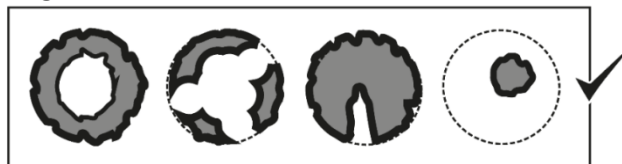
Figure 39 DHP détérioré/altéré : arbre rejeté
