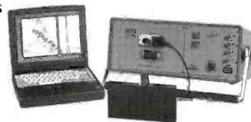
Système d'inspection à ultrason multiélément Tomoscan FOCUS™
