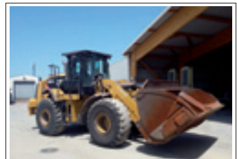
Chargeur CATERPILLAR 950K 2013 ID: 9020, 10 471 h, godet GP renforcé, système de basculement élevé, graissage central, préfiltre Turbo II. Equippo AG Email: linda@equippo.com www.equippo.com Téléphone: +41 41 544 0404
