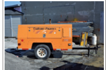
Compresseur à air SULLIVAN modèle D250 Q, moteur diesel John Deere.
