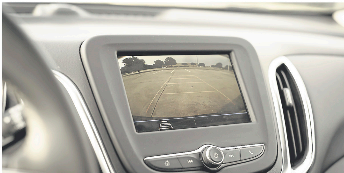
La caméra de recul projette un champ de vision limité avec un angle qui peut fausser les distances.
