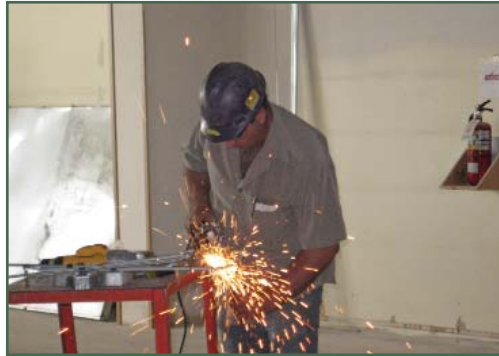
Lunettes sur le nez, extincteur à sa portée, notre soudeur est fin prêt pour meuler.
