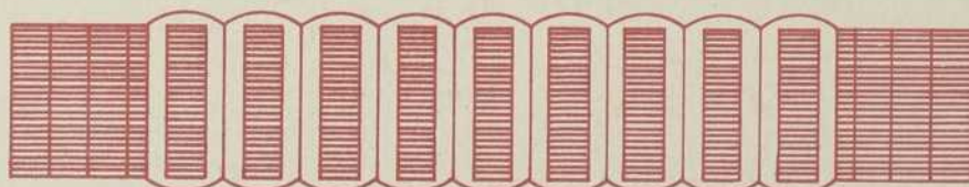
Figure 5: Bobine autour des 9 dents centrales
