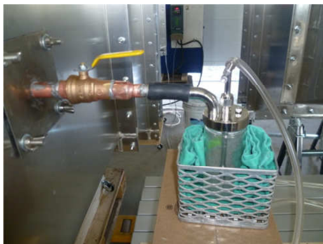
Figure 3 Dispositif expérimental pour la nébulisation des aérosols viraux
