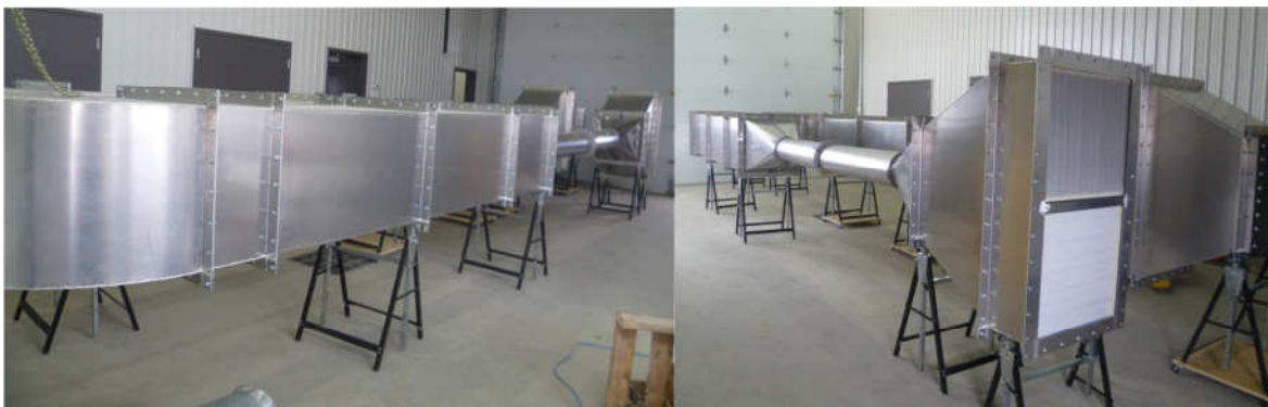
Figure 2 Banc d'essai employé pour étudier les diverses unités de filtration
