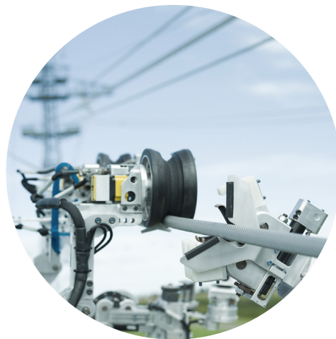
— LineScout: Un robot para inspeccionar líneas de transmisión vivas.
