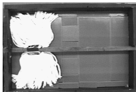
Figure 5 : Montage utilisé pour les lavages à la moppe
