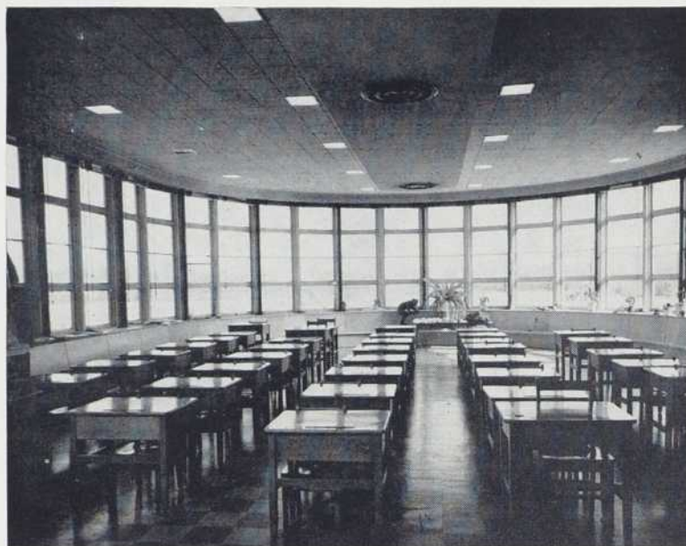
La classe maternelle. Contrairement aux autres classes (la 1ère année exceptée), elle est bâtie avec fenestration comportant de la vitre absorbant la chaleur.
