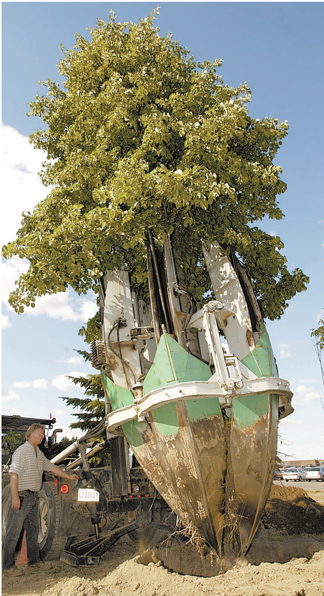
Photo ALAIN ROBERGE, La Presse © Le transplantateur TS 84 de Vermeer a extirpé du sol ce tilleul de 10 m (33 pi) en quelques minutes à peine. Il poursuivra pépèrement son existence ailleurs sur l'emplacement.
