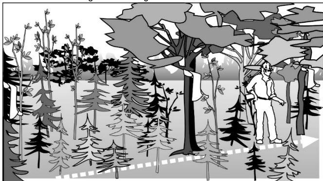
Figure A2 Balisage du cheminement chaîné
