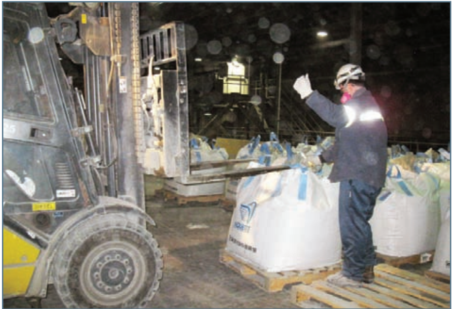
Opération de manipulation des sacs de bain de couverture.
