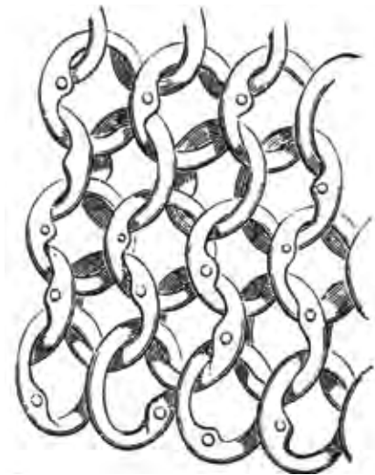
Figure 368 - Schéma illustrant l'agencement des mailles rivetées pour former une cotte
