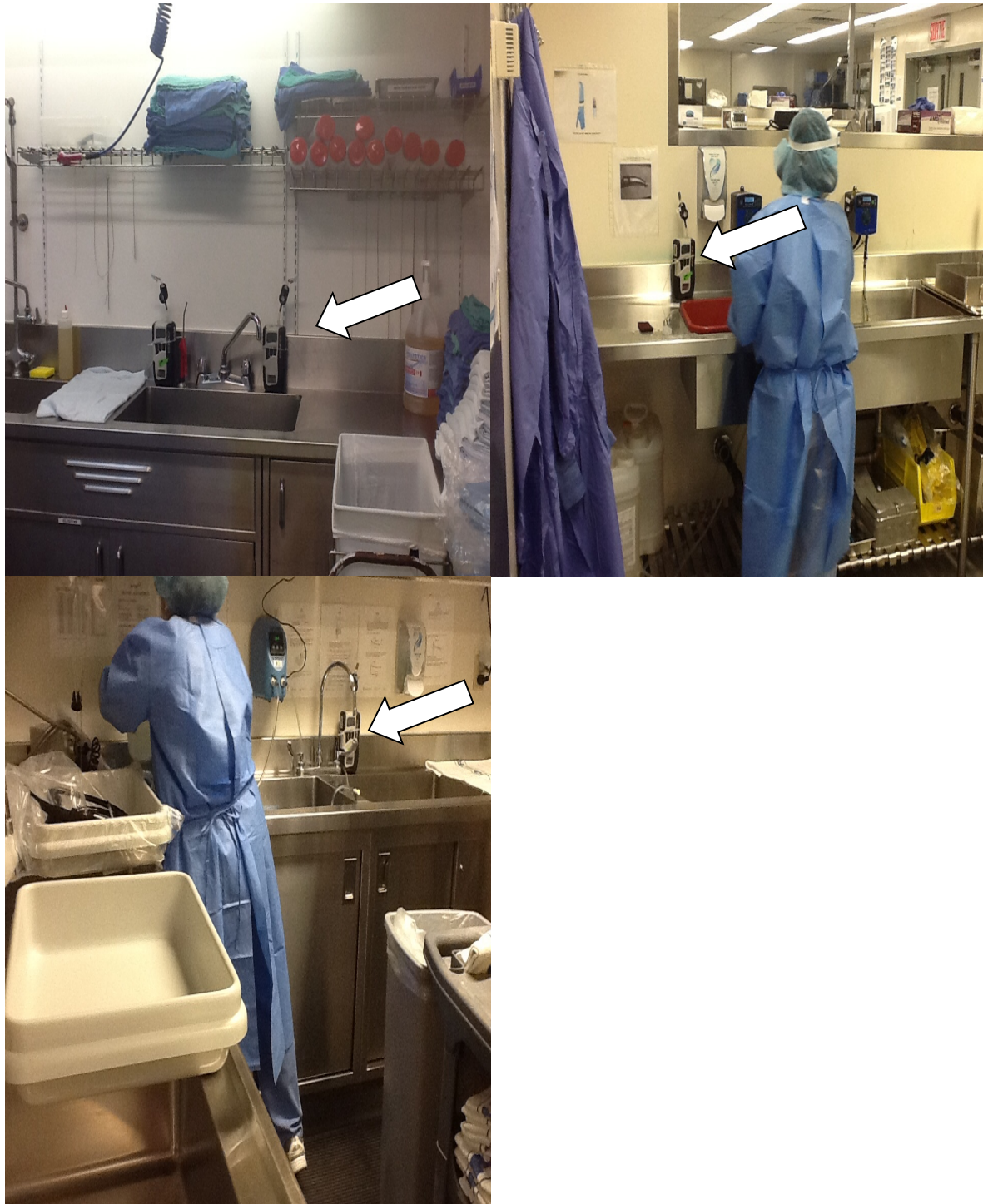
Photo 3 : Emplacement des pompes de prélèvements près des éviers dans les salles de décontaminations et de retraitement des endoscopes (prénettoyage manuel).
