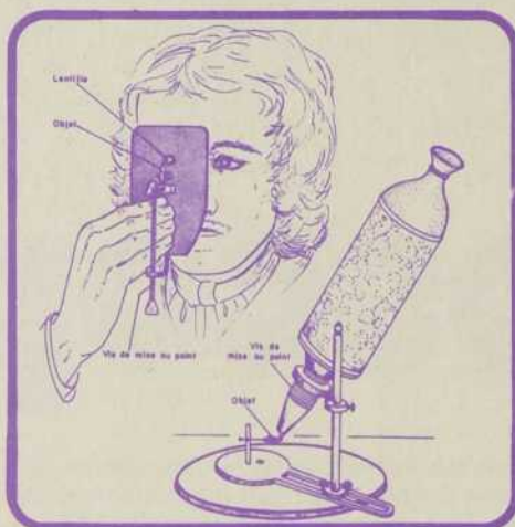
En haut, microscope à lentille unique de Loewenhook (1673). En bas, microscope de Robert Hook (1665).
