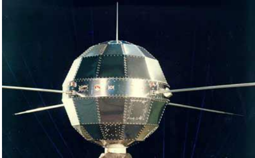
Le premier satellite chinois, DFH-1, une sphère d'un mètre de diamètre.
