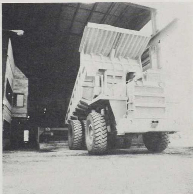
Camion de 50 T. alimentant le concasseur.
