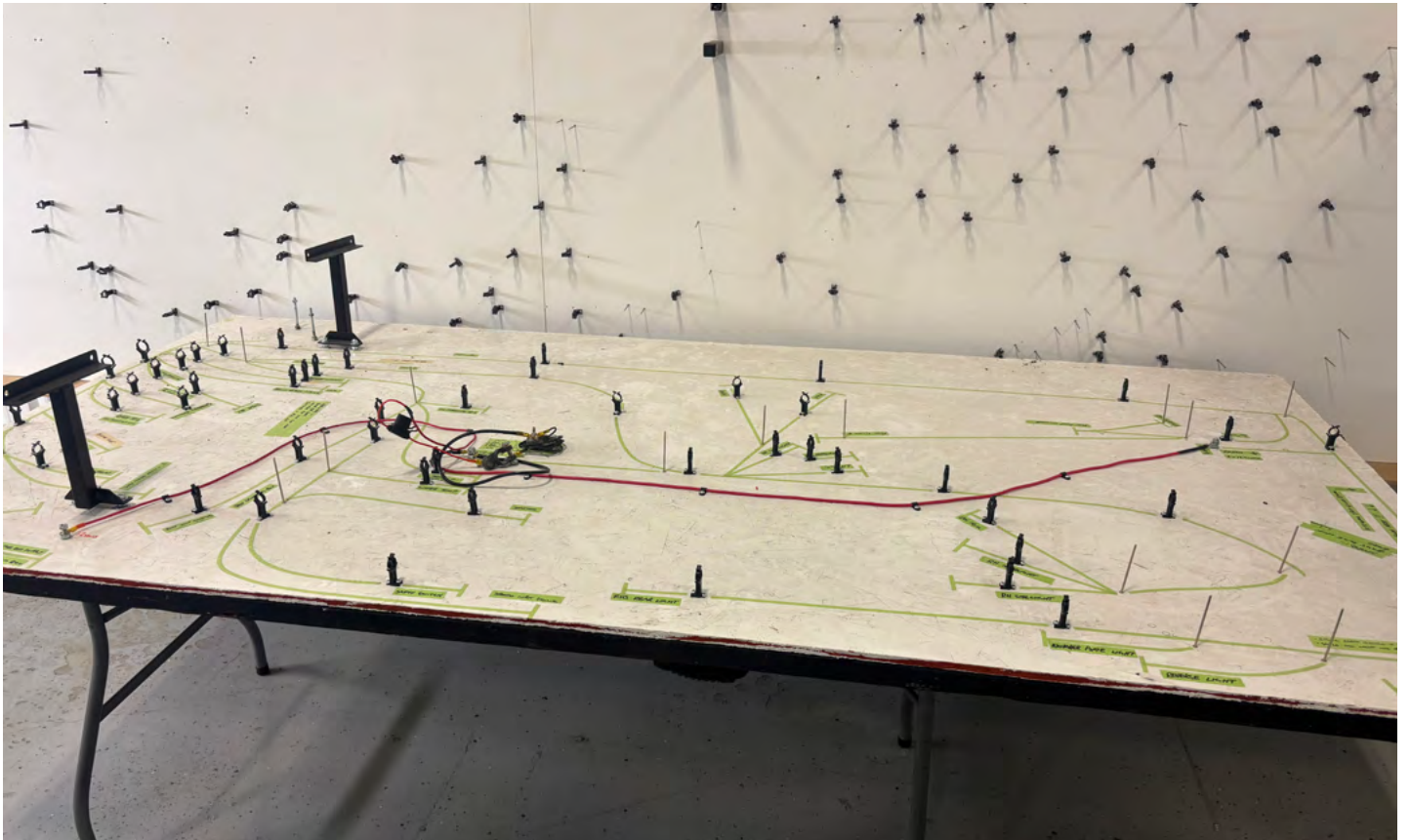
▲ Cette table sert de plan de travail pour le câblage électrique d'une Allard. (Photo Éric Descarries)
