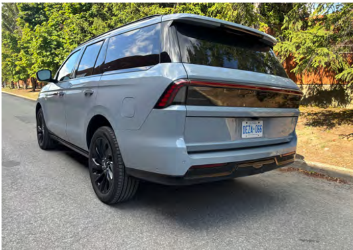
▲ L'arrière de la Navigator vient d'être redessinée. Notez que le hayon est maintenant divisé en deux avec une partie supérieure qui se soulève et une partie inférieure qui se rabat pour des « tailgate parties ». (Photo Éric Descarries)
