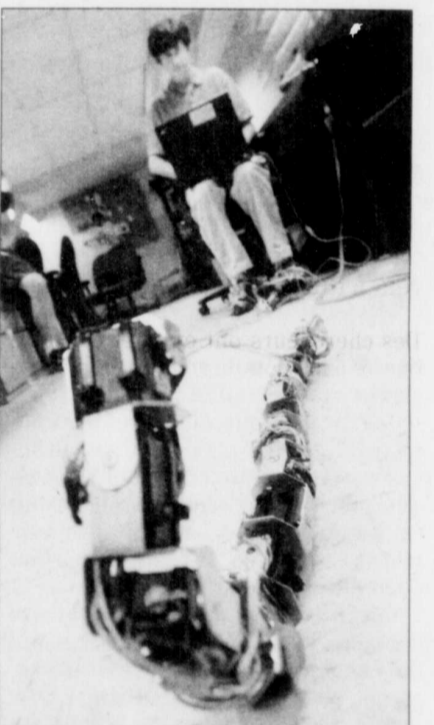
Les robots-serpents munis de caméras ont la longueur d'un bras humain. Ils peuvent être manipulés à distance.
