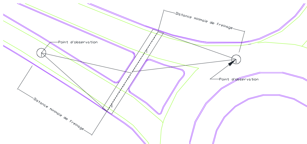
Figure 5.1-26 Grilles de calcul types pour les passages pour piétons d'un carrefour giratoire
