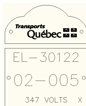
Figure 4.7-5 Plaque d'identification installée sur le terrain sur un site (fût) supportant un équipement d'éclairage
