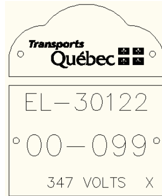
Figure 4.7-4 Plaque d'identification installée sur le terrain sur un fût (site) supportant un autre type de coffret (par exemple : coffret spécial)
