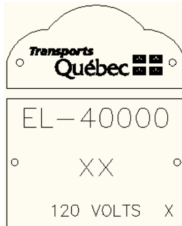
Figure 4.7-9 Plaque d'identification installée sur le terrain sur fût (site) pour les signaux lumineux et autres systèmes
