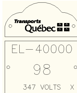
Figure 4.7-12 Plaque d'identification installée sur le terrain sur un fût (site) supportant un autre type de coffret (par ex. : relève, spécial, etc.)
