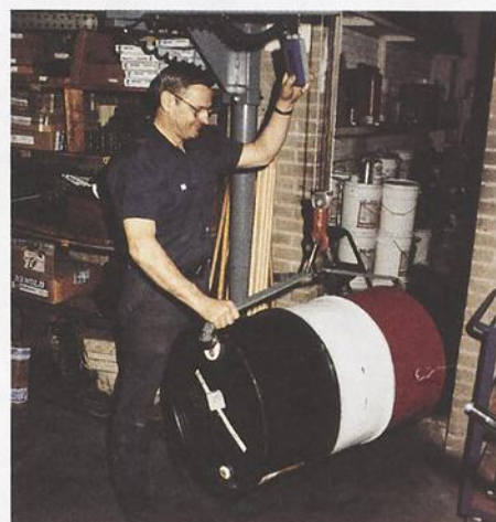
Denis Brochu, mécanicien industriel, a conçu et fabriqué un levier électrique pour transporter les barils dans la chambre d'entrepôt. Le marche-pied servant de barrage en cas de déversement, il n'était pas question de l'éliminer pour faciliter l'opération.
