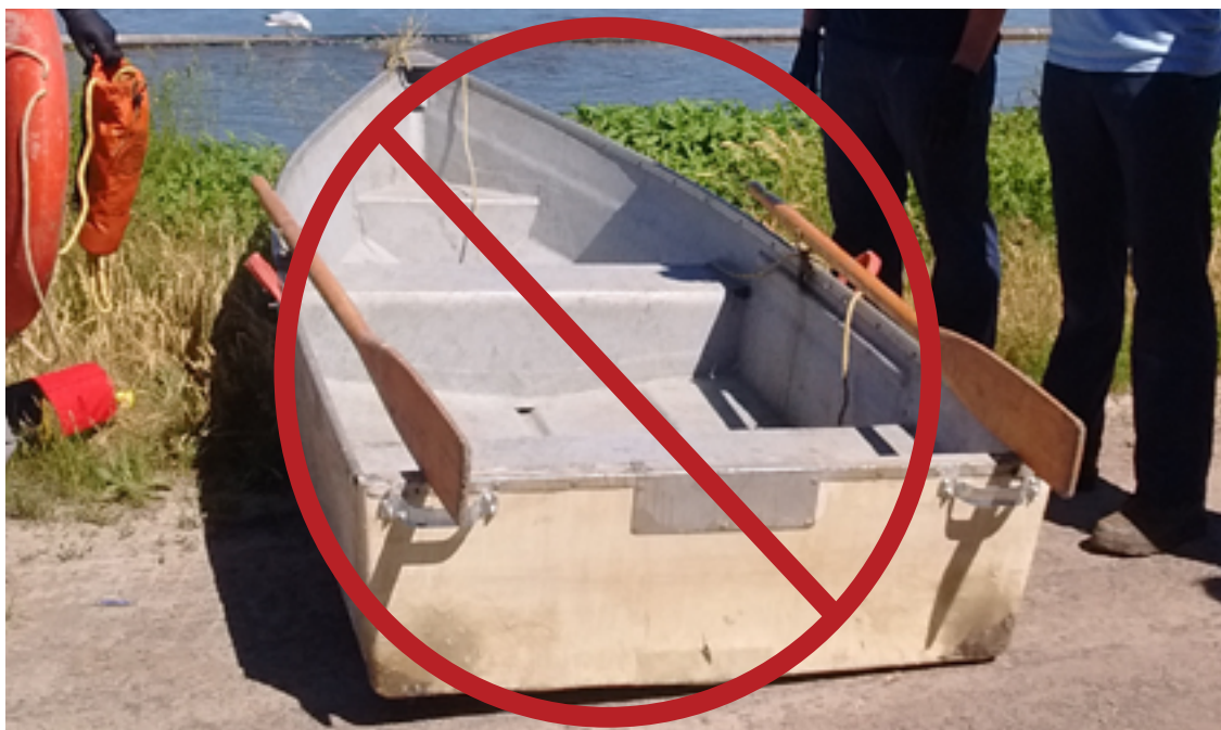
Photo 7.3. Exemple d'une embarcation non conforme : elle est conçue pour recevoir un moteur et ne porte pas de vignette de conformité. Il n'y a aucune information sur la capacité de charge.
