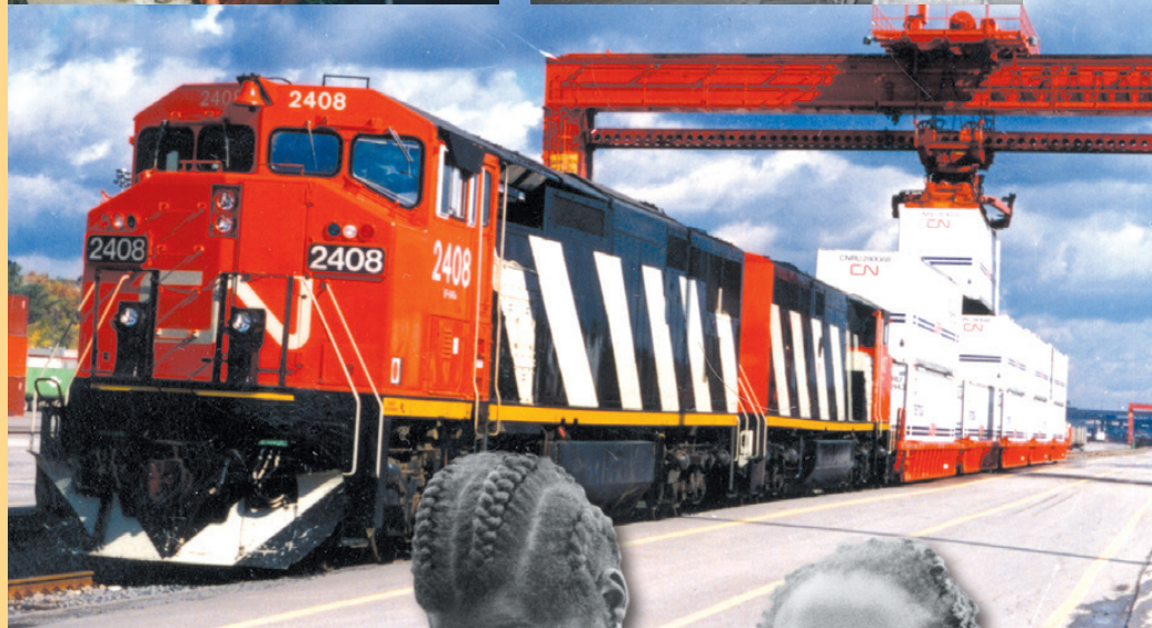
Locomotive diesel de General Electric type Dash 8-40CM 2408 avec des wagons Five-Pak au terminal à conteneurs de Montréal, octobre 1990. Collection CN. Photo : Jean Heguy.
