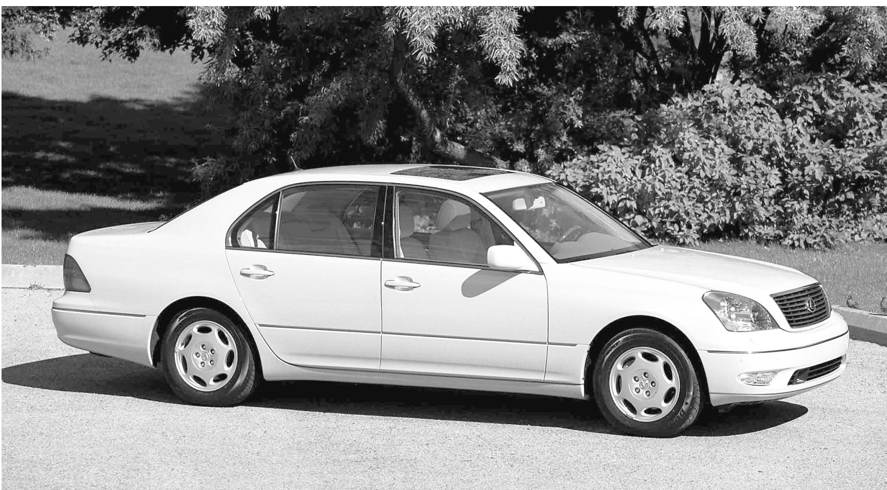
Silhouette anonyme sans doute, mais terriblement efficace sur le plan aérodynamique. La LS430 revendique un coefficient de traînée aérodynamique de 0,26 (0,25 lorsque ce haut de gamme repose sur suspension pneumatique).
