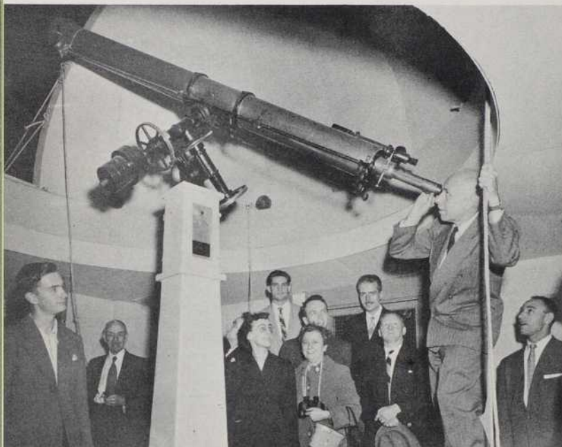
M. Frank de Kinder est à l'oculaire du télescope réfracteur de 6 pouces. En tirant sur les câbles, de sa main gauche, il fait tourner le dôme de l'observatoire au fur à mesure que le mouvement de la Terre l'exige.
