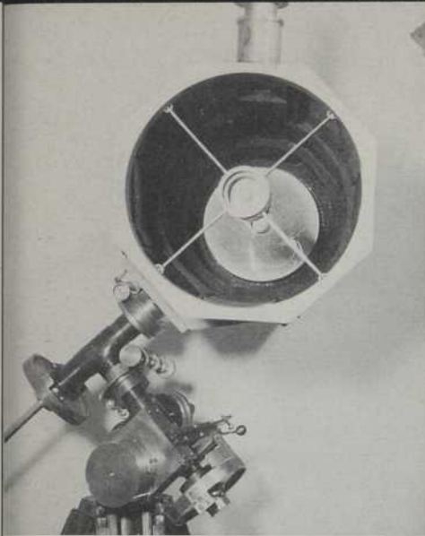
Intérieur d'un télescope réflecteur de Newton. Au fond du tube, un miroir concave et parabolique réfléchit la lumière de l'astre en la concentrant au foyer, c'est-à-dire à l'orifice de l'appareil où un petit miroir placé à un angle de 45^\circ (soutenu par les quatre tiges) renvoie l'image à l'oculaire, sur le dessus. Le miroir de cet appareil a été poli par M. Robert Venor, membre de la Société Royale d'Astronomie, à Montréal.
